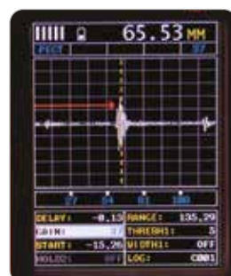
PECT Impulsion - Echo Coating (PECT) Affiche à la fois l'épaisseur de matériau (PE) et l'épaisseur de revêtement (CT)
